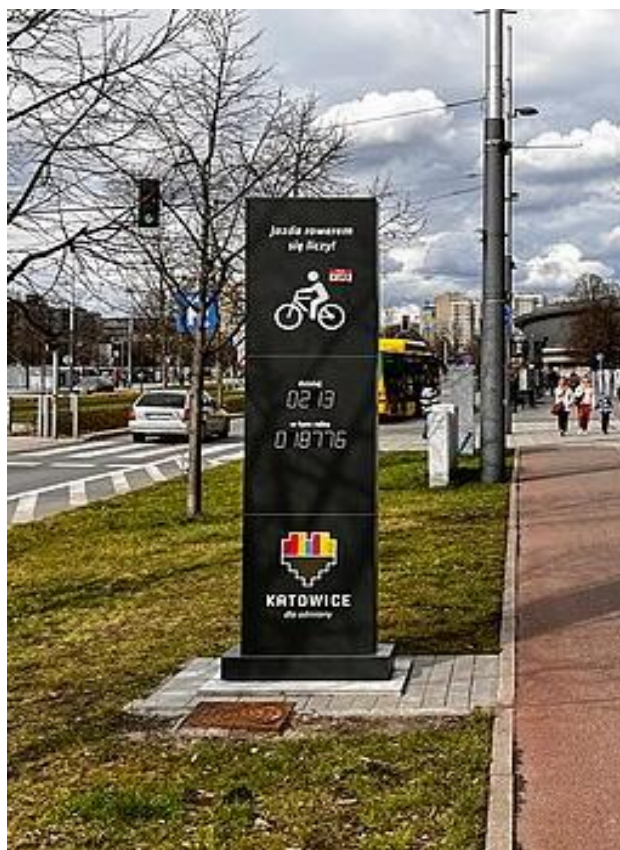
Rys. 2 Licznik do pomiaru ruchu rowerowego zlokalizowany na Al. Korfantego
