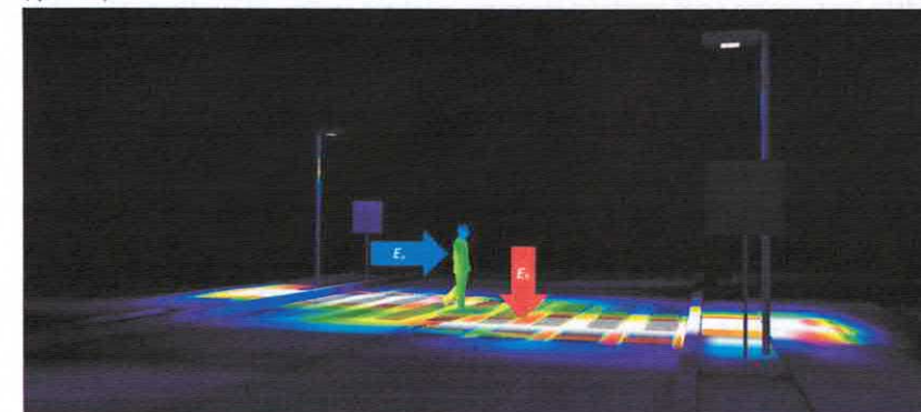
Rys. 1.3 Schemat obrazujący pomiar składowych natężeń oświetlenia: natężenie oświetlenia w płaszczyźnie pionowej E_v i natężenie oświetlenia w płaszczyźnie poziomej E_h Źródło: Opracowanie własne
